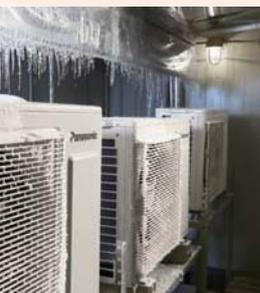
最高55℃から最低-30℃もの過酷な温度環境下での運転試験
